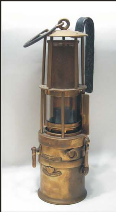
Acetylen-Sicherheitslampe von Friemann & Wolf (Modell 800) aus dem Glanzkohlebergbau Fohnsdorf (um 1910).
