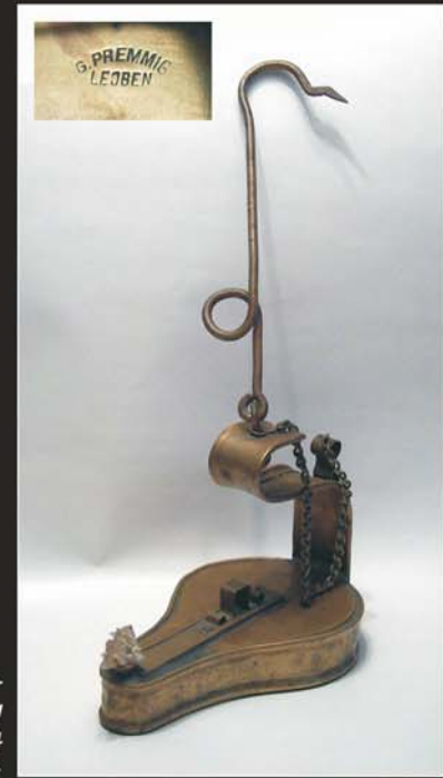
Froschlampe für Ölbrand von Premmig aus dem Kohlebergbau Seegraben (um 1880).
