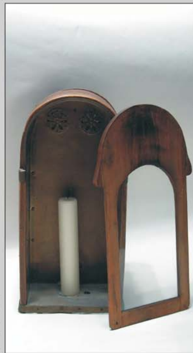
Blende für Kerzenbrand aus dem steirischen Salzkammergut (Ausseer Salzberg; um 1870).
